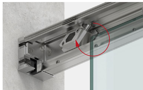
Vor dem Einbau den Gummipuffer entfernen. Danach den Türanschlag in die Laufschiene eindrehen und Gummipuffer wieder aufstecken. Detach the rubber before installation. Then rotate the door-stop into the the guide rail and reattach the rubber.
